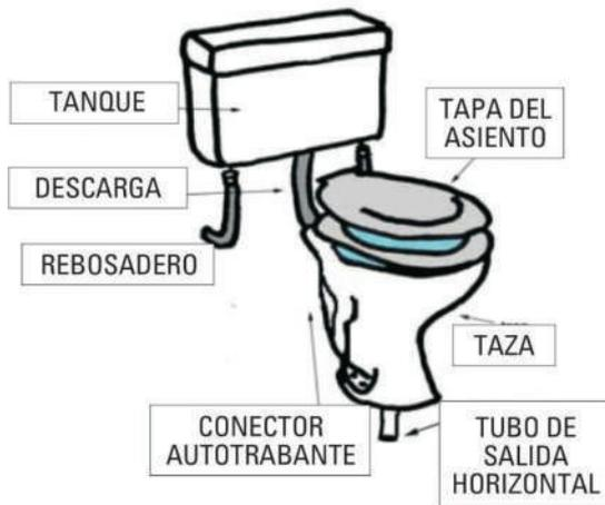
Dentro del tanque existen dos mecanismos principales: el surtidor y la válvula de descarga. El surtidor permite el llenado del tanque, es accionado generalmente por un flotador (*existen otros mecanismos*) que al subir el nivel del agua dentro del tanque cierra la válvula de acceso del agua, cuando el tanque se descarga permite la entrada de agua hasta el nivel en que el flotador la vuelve a cerrar.
